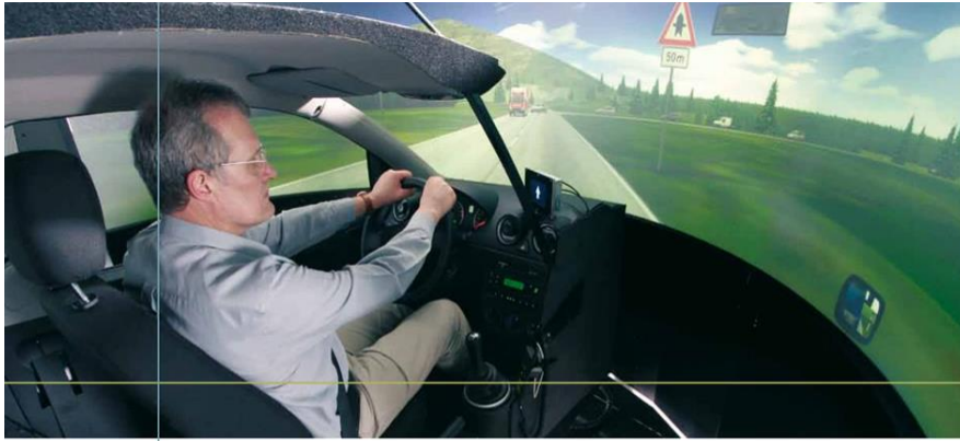
Bild 9 Fahrsimulator als Instrument betrieblicher Verkehrssicherheitsarbeit der Unfallkassen und Berufsgenossenschaften – die Laborsimulation dient der Quantifizierung des Ablenkungspotenzials und zugleich den erforderlichen Aufklärungs- und Trainingszwecken (Foto zit. nach UK/BG, Cover-Ausschnitt)
