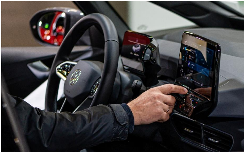
Bild 5 Touchscreen und Touch-Slider statt Knopf, Schiebe- und Drehregler – erfordern neue Bedienkonzepte ein höheres Maß an Auge-Handkoordination? (Foto © Adobe Stock)
