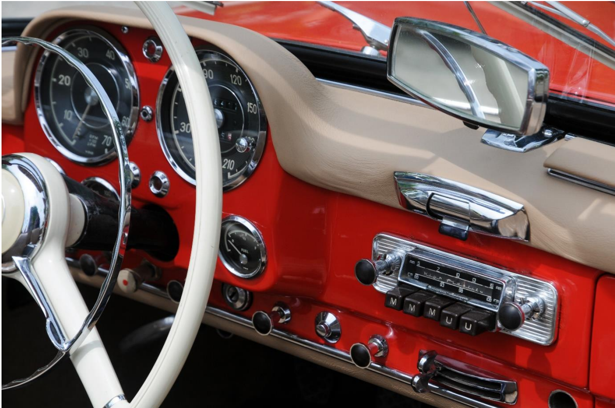
Bild 48 Das Autoradio gehört zu den am häufigsten genutzten Funktionalitäten und sollte in jeder Form mit einem Minimum an Bedienschritten auskommen und auch im Borcomputer-Menü eine priorisierte Stellung einnehmen (Foto © Adobe Stock)
